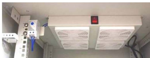
Internal Fan Assembly
